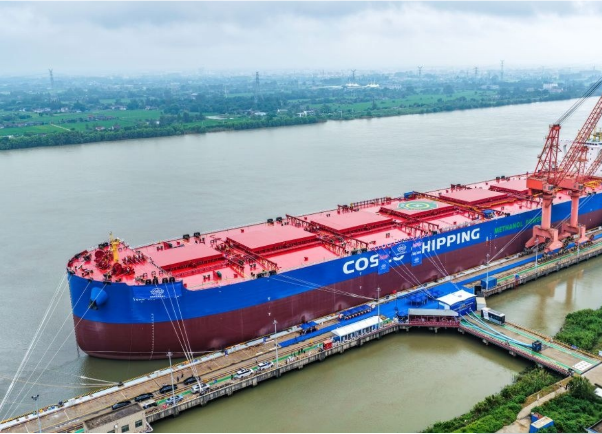
全球首艘32.5万吨甲醇双燃料矿砂船建造完工 近日,全球首艘32.5万吨甲醇双燃料矿砂船在江苏扬州建造完工并命名为“远海丝路”轮。该船由扬州中远海运重工有限公司承建,船长339.9米、型宽62米,一次可装载32.5万吨铁矿石。在绿色动力方面,该船单次加注甲醇可续航2万海里。图为停泊在扬州中远海运重工有限公司3号码头的“远海丝路”轮。 新华社供图
